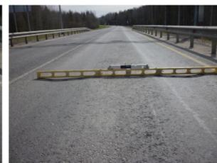
б) Измерения поперечной ровности рейкой дорожной универсальной РДУ-АНДОР
