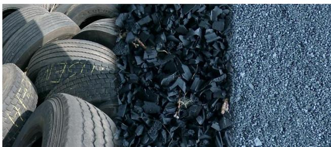
Рис. 2. Резиновая крошка, полученная из переработанных шин
