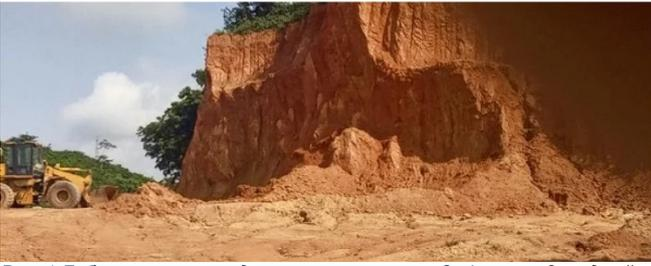
Рис. 1 Добыча патерита для строительства, Софокром, Западный регион, Гана [9]
