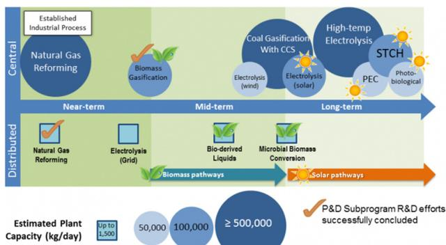
Рисунок 1: Пути производства водорода.
