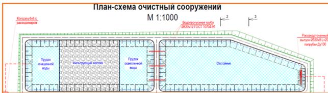
Рисунок 1 – Существующая схема очистки карьерных вод разреза «Правобережный»
