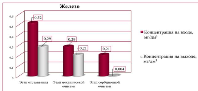
Рисунок 5 – Снижение концентраций взвешенных веществ, нефтепродуктов, железа на этапах очистки
