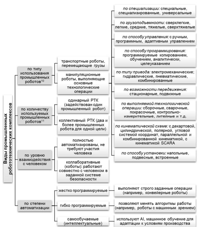
Рис. 4 – Классификация робототехнических промышленных комплексов
