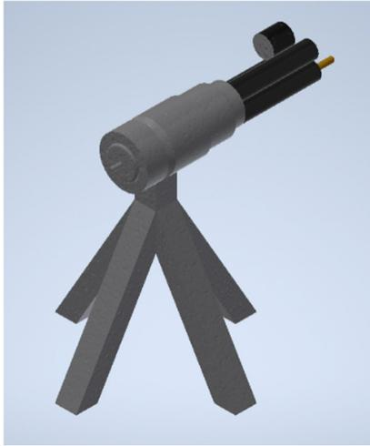
Рис. 1 – модель датчика с мультисенсорным типом, совмещающим несколько сенсоров в 1 корпусе
